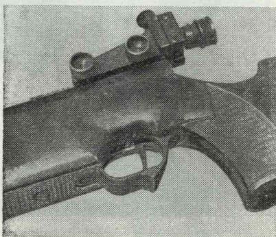
Рис. 8. Расположение регулировочного винта натяжения спуска
